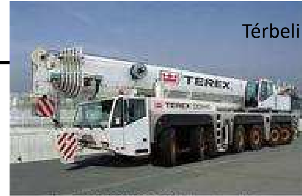
1. ábra TEREX DEMAG AC250-1 típusú autódaruja
