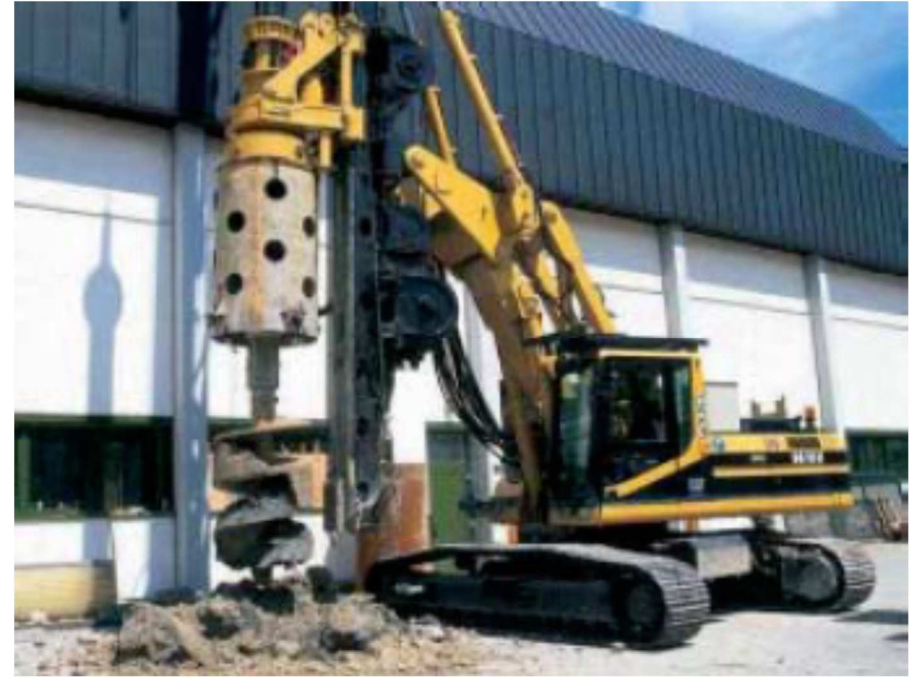
Boring (auger) equipment Talajfúró berendezés
