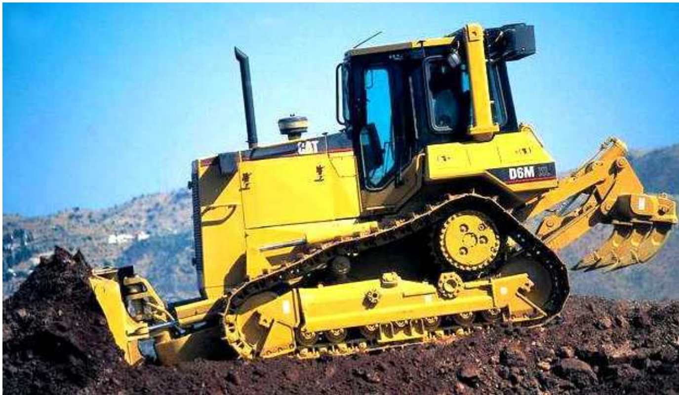
Bulldozer equipped with ripper attachment Talajlazító berendezéssel felszerelt földtoló
