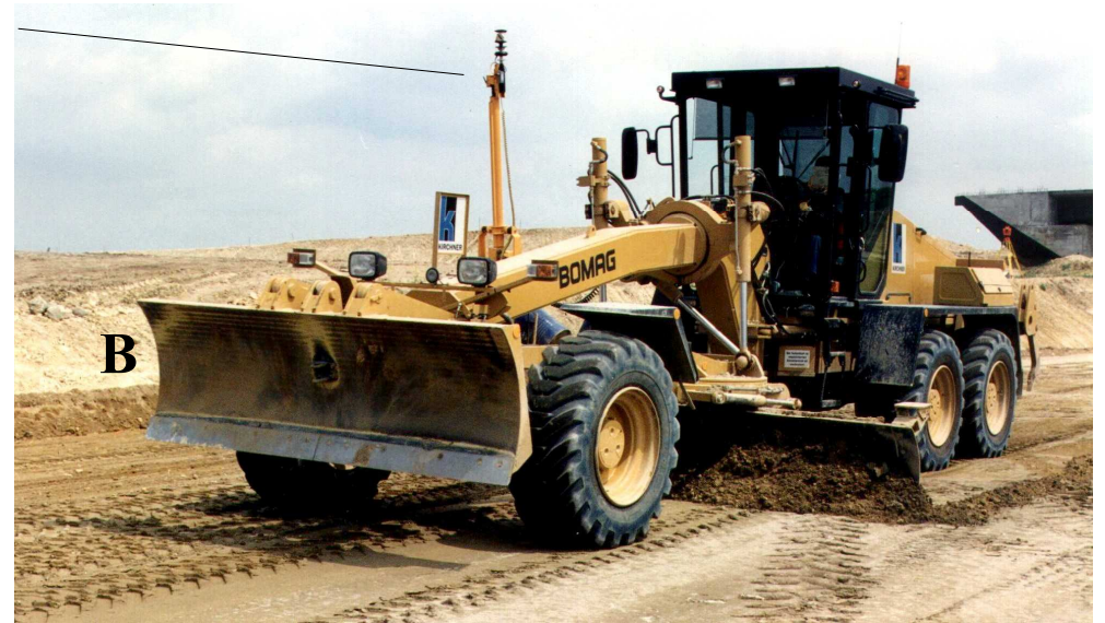
Laser controlled (C) grader equipped with ripper (A) and front blade (B) attachment Lézer vezérlésű (C) földgyalu, talajlazító (A) és elülső tolólap (B) kiegészítő szerelésekkel
