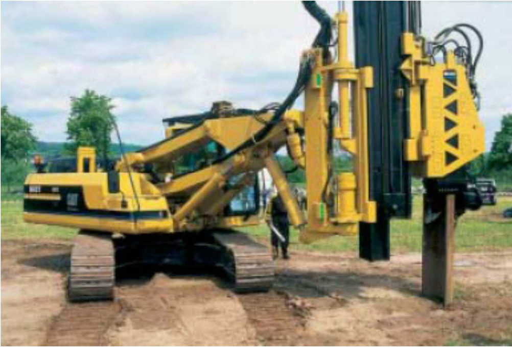
Sheet-wall piling equipment szádfalverő berendezés
