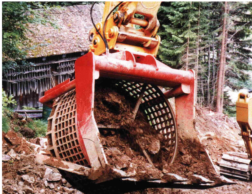
Screening adapter (for recycled material) Forgórosta (helyben újrahasznosított anyaghoz)
