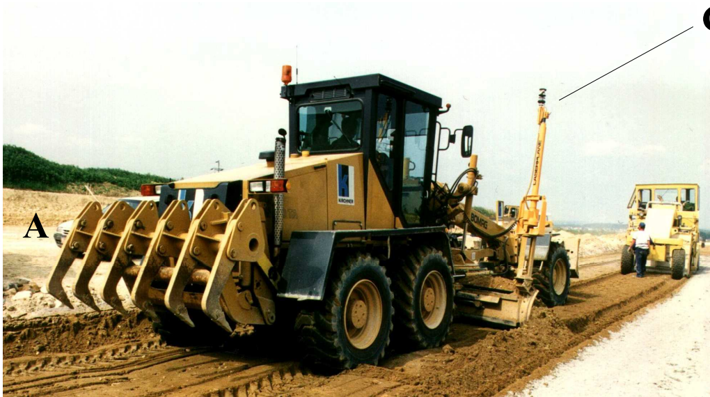
Laser controlled (C) grader equipped with ripper (A) and front blade (B) attachment Lézer vezérlésű (C) földgyalu, talajlazító (A) és elülső tolólap (B) kiegészítő szerelésekkel
