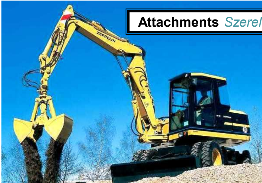
Clamshell bucket (for granular material) Markoló kanál (szemcsés anyaghoz)
