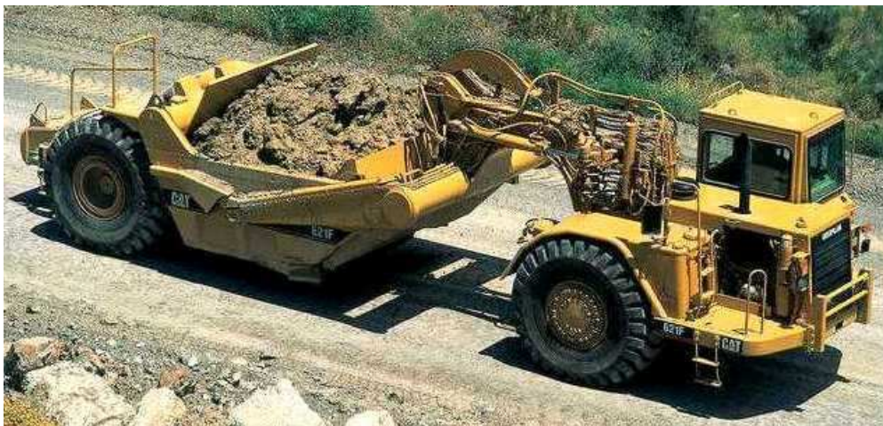
Hauling excavated soil Fejtett föld szállítása
