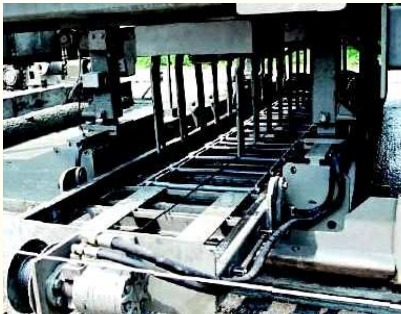
Longitudinal joint-bar inserter Hosszirányú vasalás
