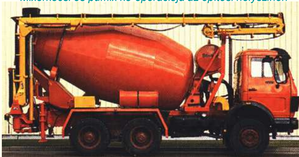
Mixer truck with delivery conveyor (riding position) Feladószalagos mixerkocsi (utazó helyzetben)
