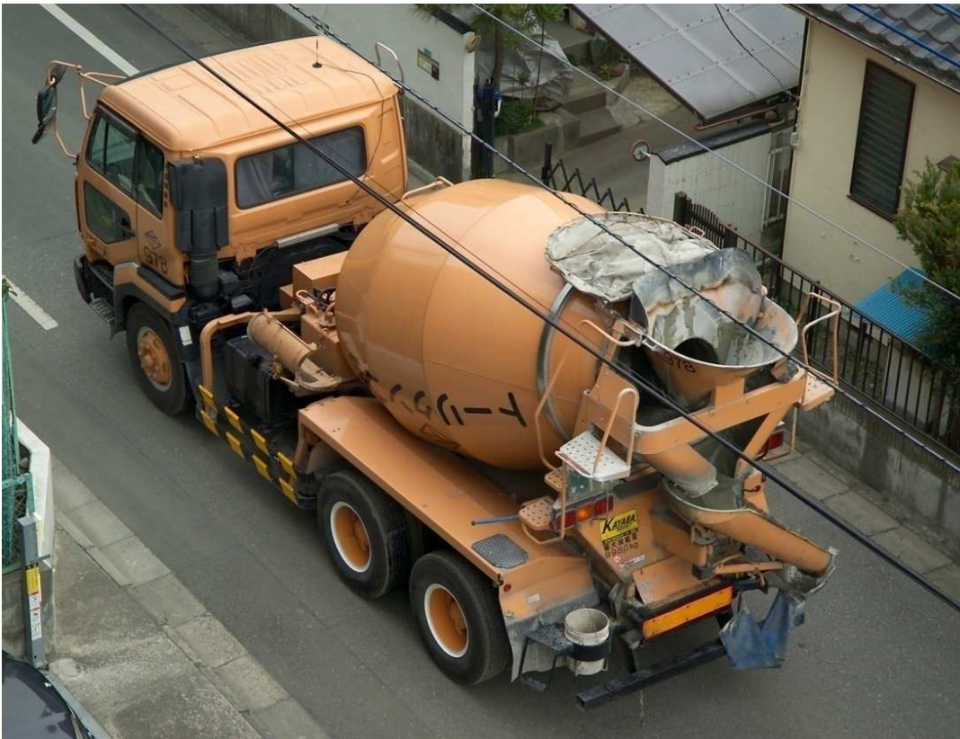
Mixer truck (charger chute open) Mixerkocsi (nyitott töltőnyílással)
