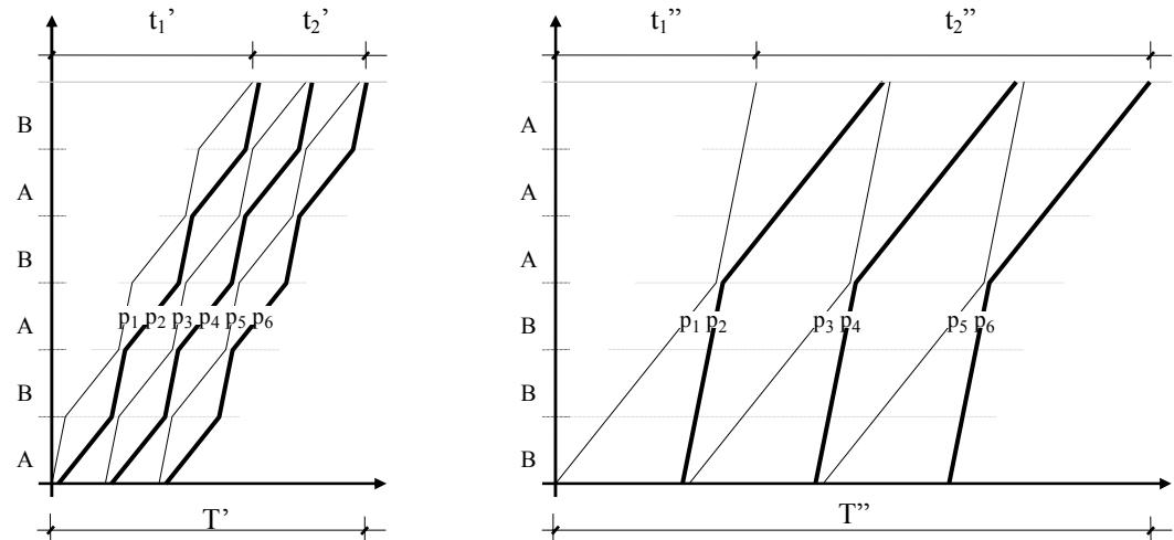
$$\frac{T'}{T''} = \frac{t_1' + t_2'}{t_1'' + t_2''} \approx \frac{m \cdot D_a + (n-1) \cdot D_a}{m \cdot D_a + m \cdot n \cdot D_a} = \frac{(m+n-1) \cdot D_a}{m \cdot (n+1) \cdot D_a} = \frac{m+n-1}{m \cdot (n+1)}$$
