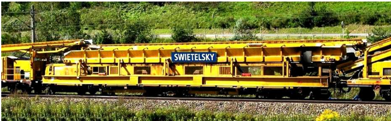
Önürítő tartálykocsik az anyagfeladó és -kihordó szállítószalagokkal
