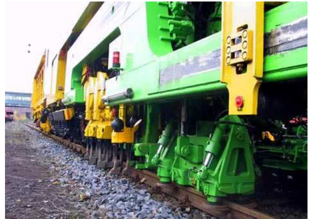
Kitérő aláverése: kiforgatható aláverő (a, b), kitőlható vágányemelő (c)
