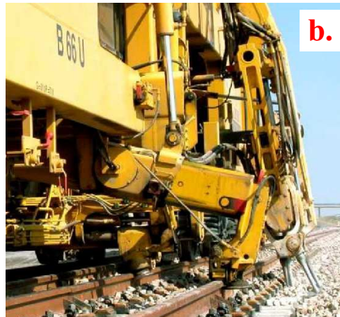
Kitérő aláverése: kiforgatható aláverő (a, b), kitőlható vágányemelő (c)
