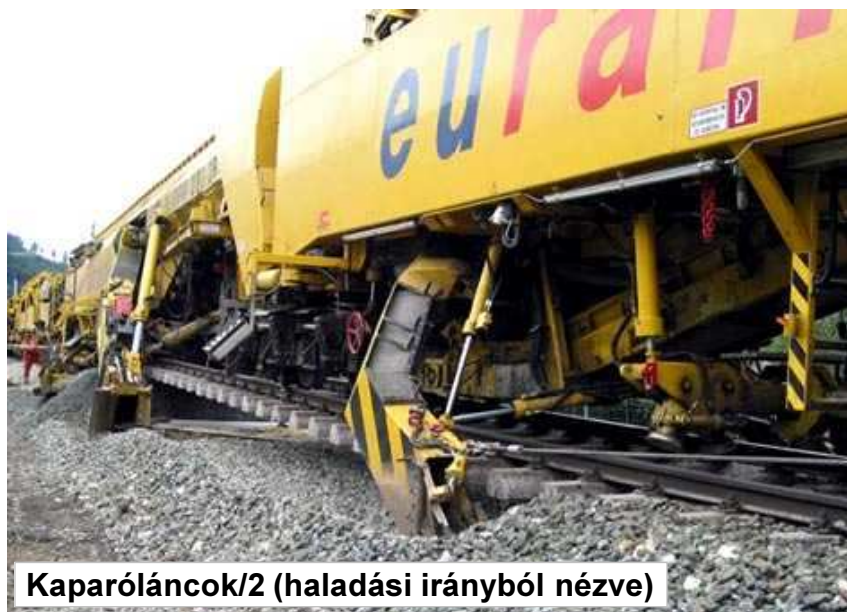
A felújító szerelvény
