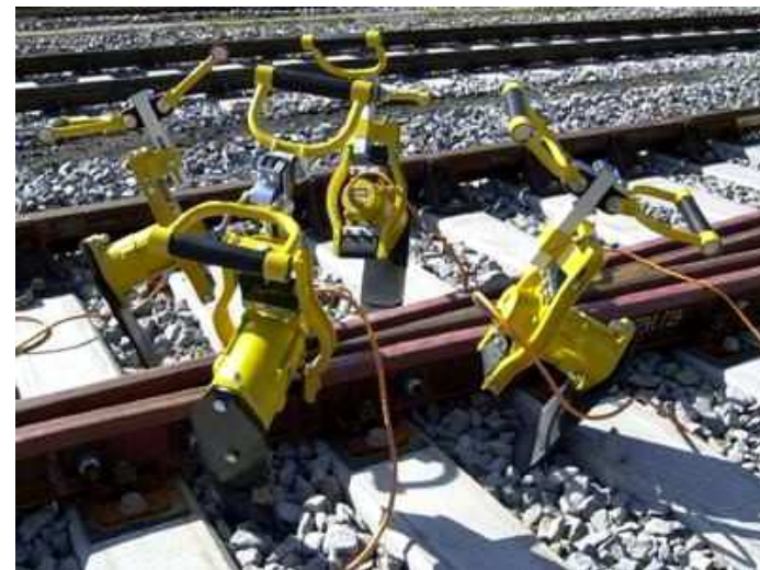
Egykaros, aláverő kisgépek (munkavégzéshez előkészítve)
