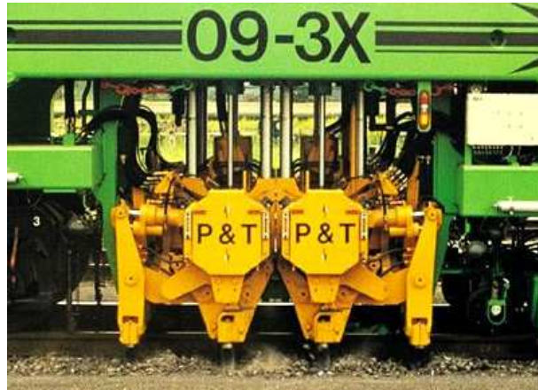
Kitérő aláverése: kiforgatható aláverő (a, b), kitőlható vágányemelő (c)
