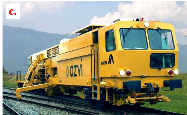
Kitérő aláverése: kiforgatható aláverő (a, b), kitőlható vágányemelő (c)
